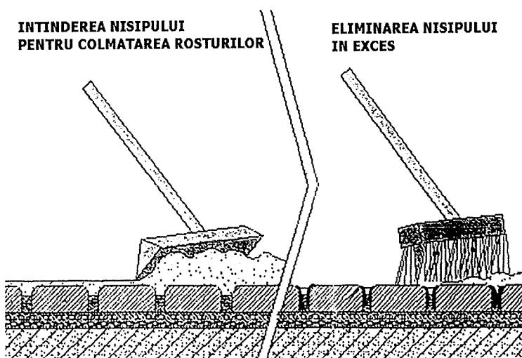
Se începe cu o primă colmatare înainte de vibrocompactare cu scopul de a accelera și îmbunătăți umplerea rosturilor. Apoi se aşterne din nou nisip de colmatare și se freacă cu peria pentru a împinge nisipul în rosturi. Întrucât colmatarea rosturilor este graduală se recomandă să nu se efectueze imediat curățirea finală.
