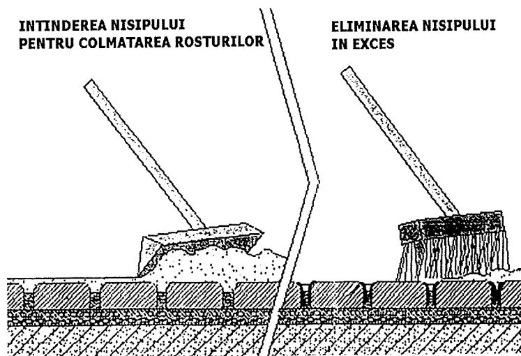
Se începe cu o primă colmatare înainte de vibrocompactare cu scopul de a accelera și îmbunătăți umplerea rosturilor. Apoi se aşterne din nou nisipul de colmatare și se freacă cu peria pentru a împinge nisipul în rosturi. Întrucât colmatarea rosturilor este graduală se recomandă să nu se efectueze imediat curățirea finală.
